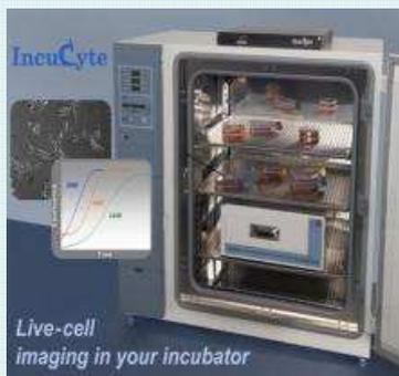
Cet appareil permet de réaliser des cinétiques de la prolifération cellulaire dans des conditions de culture classiques sous atmosphère contrôlée en quantifiant la confluence des cellules.
